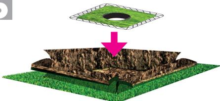
Manschette direkt über dem Loch für den Torpfosten positionieren und festklopfen.
